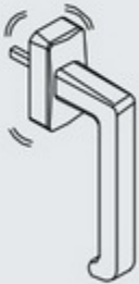
VİDALAR GEVŞEMİŞ PENCERE KOLU SCREWS LOOSE WINDOW HANDLE
